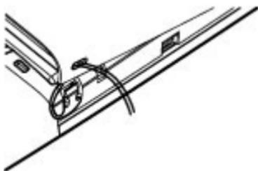
取下手机后盖，并按图示穿入腕带，将腕带系紧，然后装回后盖。
