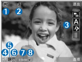
要显示所有的取景窗口指示符号，请选择选项 > 显示图标。如果选择不显示图标，则只显示视频状态指示符号、可用的录制时间(录制过程中)、缩放指示条(缩放时)以及选择键。
