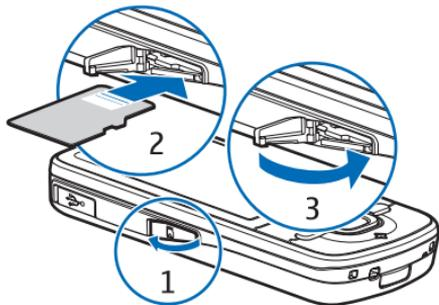
2. 将存储卡插入插槽，使金色触点朝下。轻推存储卡使其锁定到位。
