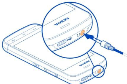
请勿连接能够生成输出信号的产品，以免损坏设备。请勿将任何电压源连接至诺基亚 AV 插孔。如果连接至诺基亚 AV 插孔的任何外置设备或任何耳机未经诺基亚认可能够与本设备一起使用，请特别注意音量。
