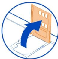
5 确保 SIM 卡的触点朝向手机，将 SIM 卡滑入 SIM 卡卡夹中。
