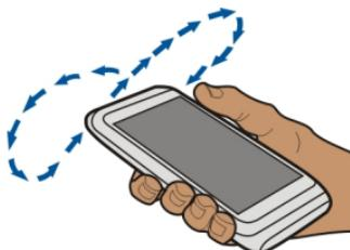
指南针的准确性有限，并且电磁场、金属物体或其他外部环境可能会影响指南针的准确性。应始终对指南针进行正确校准。
