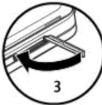
3 關上 SIM 卡插槽外蓋。請確認插槽外蓋已確實關閉。
