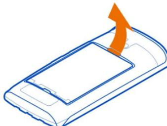
4 要松开 SIM 卡夹, 请按照卡夹上箭头所指的方向滑动卡夹。提起卡夹。
