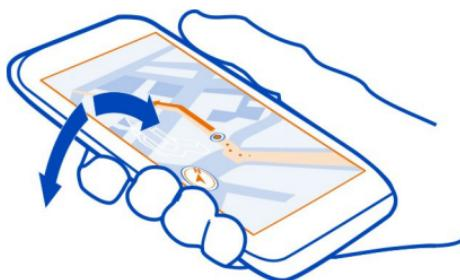
指南针的准确性有限，并且电磁场、金属物体或其他外部环境可能会影响指南针的准确性。应始终对指南针进行正确校准。
