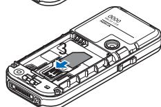
確認 SIM 卡上的金色接觸點朝下，將 SIM 卡插入 SIM 卡插槽，直到固定在正確位置為止 (3)。
