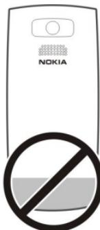
Gambar menunjukkan bidang antena GSM berwarna abu-abu.
