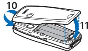
Posisikan bagian atas penutup belakang di atas telepon (10). Tekan bagian bawah penutup belakang ke arah telepon sampai penutup terpasang dengan benar (11).
