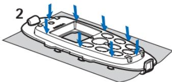
6. Tekan kuat perforator pada masing-masing tepinya ke arah dudukan hingga gambar terpotong keluar dari lembaran kertas. Gunakan tenaga untuk melakukan hal ini.
